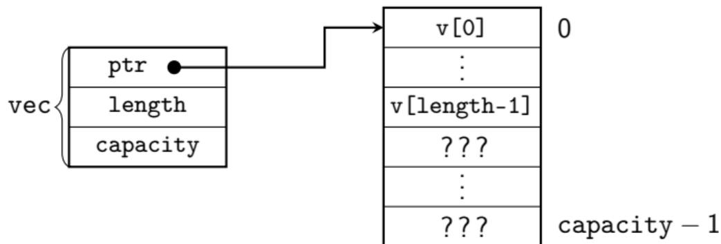
**Opérationnellement**, le transfert d'un `Vec` ne copie que les champs `ptr`, `length` et `capacity`.
